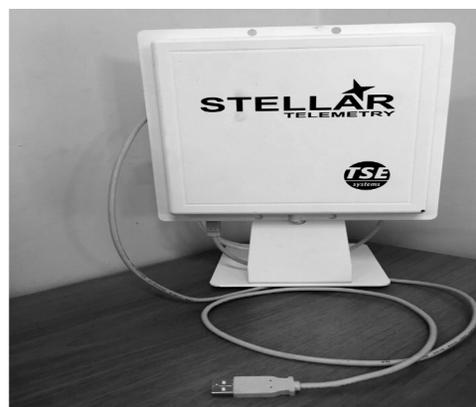
**Рис.1.** Система инвазивной телеметрии Stellar (430001-REC- TSE) Systems
