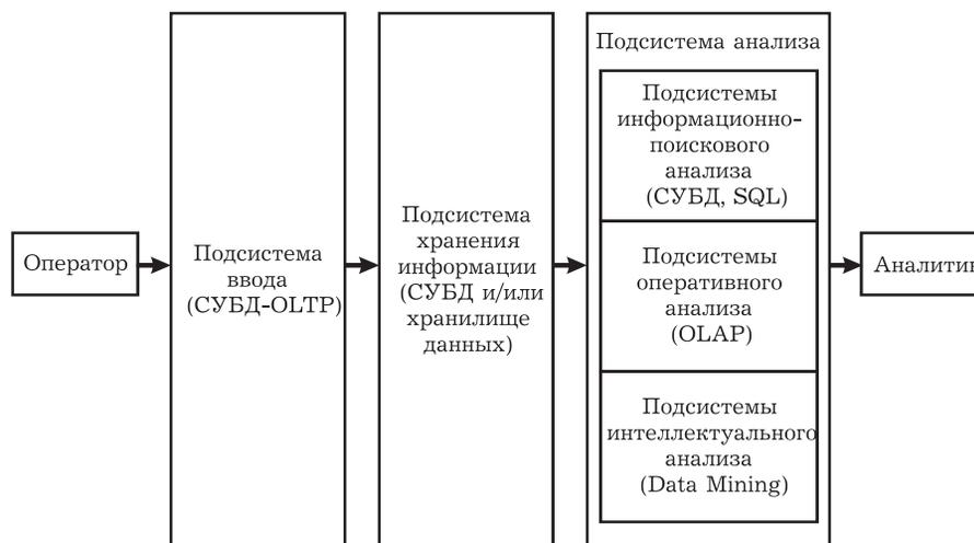
Рис. 2. Обобщенная архитектура ИАС.
