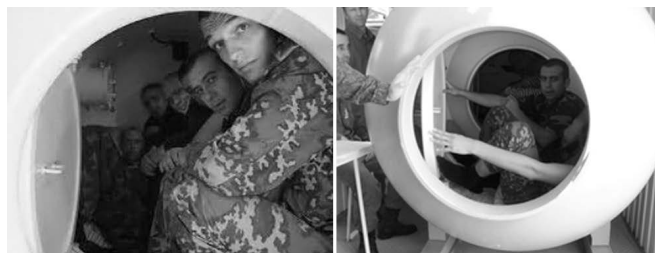
Рисунок. Размещение шести водолазов в отсеке барокамеры РБК-1400 для проведения экспериментальных водолазных спусков ( http://www.diveservice.ru/news/215 ).
