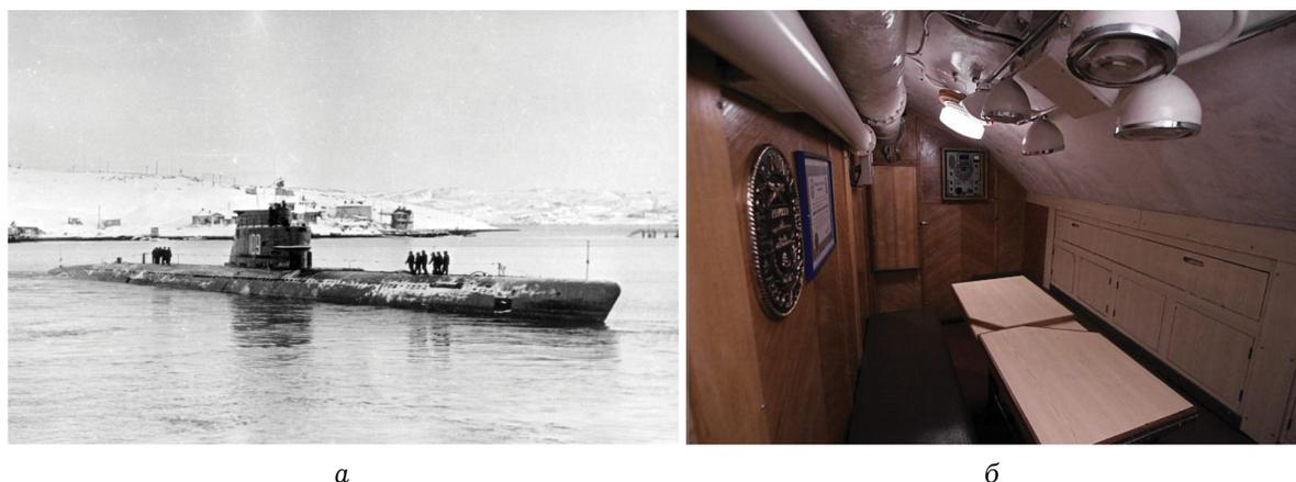
**Рис. 1.** Большая дизельная океанская подводная лодка проекта 611 (а) с предусмотренной операционной в кают-компании офицеров (б).
